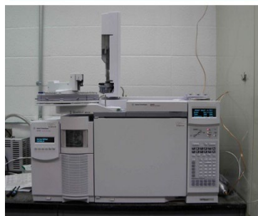
GC-MS used for SVOC analysis
